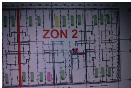
Figur 4.3. Enkel inre APD-plan som illustrerar var specifika material ska placeras.
